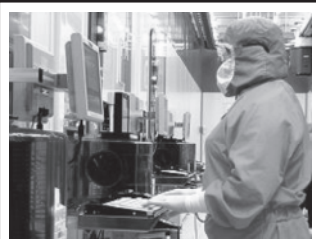
Техник на заводе Fab 11X в Нью-Мехико одет в оранжевый комбинезон, что означает, что в данном производственном процессе используется медь. Медь недавно пришла на смену алюминию в качестве соединений в широком ассортименте продукции Intel.
